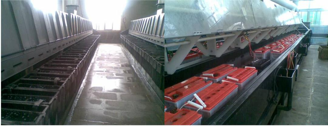
图 10 槽化成和电池化成示意图
