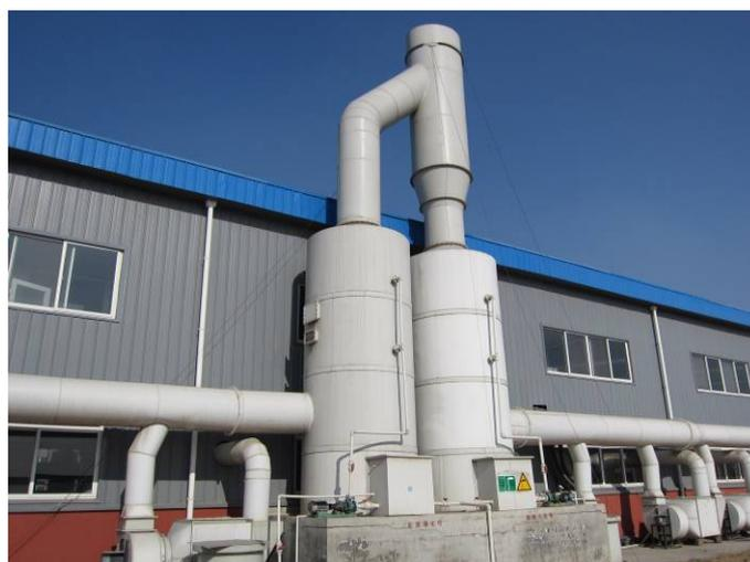
图 17 硫酸雾净化器
