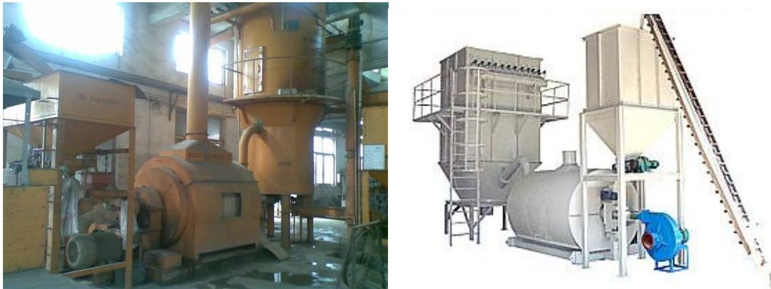
图 2 球磨铅粉机设备图
