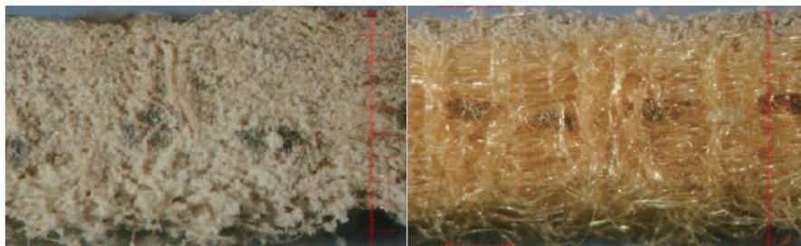
左图:传统圆形纤维滤料。水泥窑尾使用两年后,粉尘完全穿透了滤料,压差上升,能耗显著增加,过滤效果变差。
