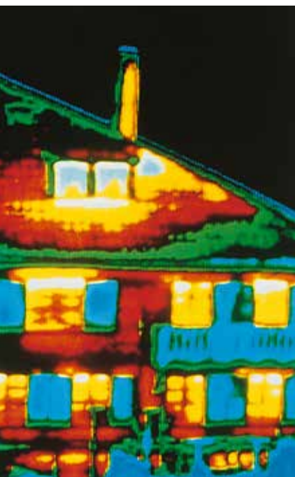
图 1：被动房保温效果可视化示意图
